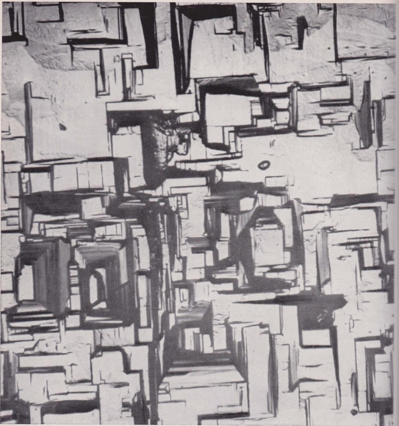
Cristalli formati in seguito al processo di vaporizzazione su un substrato di silicato (IBM).
